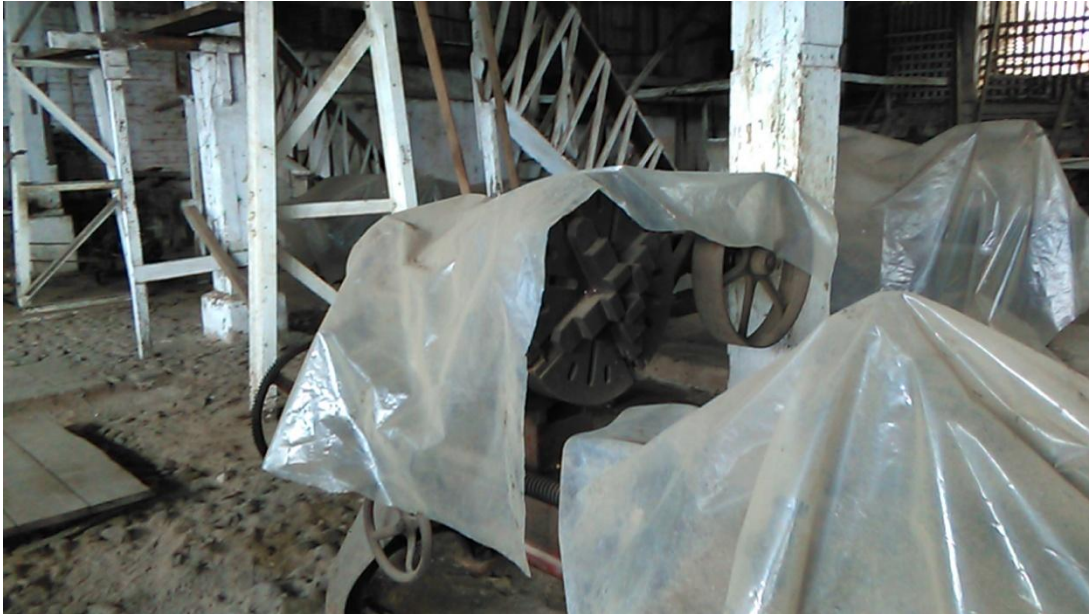
Maquinaria envueltas en plástico protegidas del polvo y las goteras, con poco sarro y menor daño en el metal, año 2018
