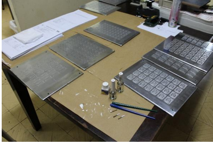
Fotografía 12. Planchas de acero con diseños para estampar. Taller Nacional de Grabados en Acero Autora: Aguirre, Isabel 2015
